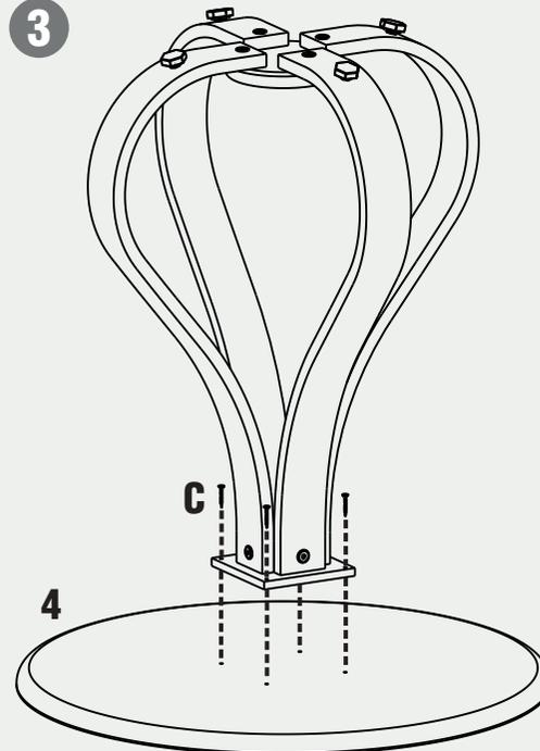
Forrar o local de montagem onde está colocado o Tampo (4). Fixar os pés montado no Tampo utilizando os parafusos C.
