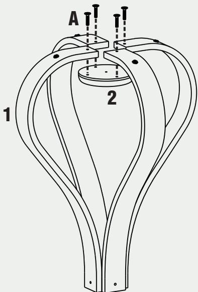
Fixar os Pés de Madeira (1) na Base Redonda Inf. (2) utilizando os parafusos A. **OBS: Em alguns modelos podem vir 8 parafusos invés de 4 (2 para cada Pé).**
