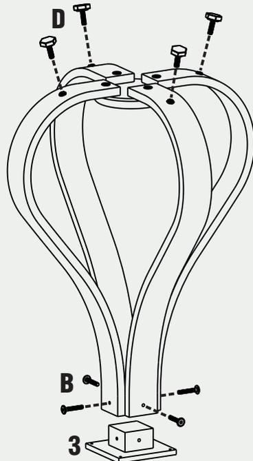
Fixar o Apoio do Tampo (3) utilizando os parafusos B e em seguida colocar as sapatas dos pés D.
