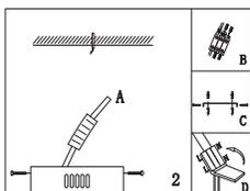
**2. CONECTE OS FIOS ELÉTRICOS COM A REDE. (CERTIFIQUE-SE QUE ELA ESTÁ DESLIGADA)**
