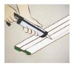
4- **Cole a barra de rodapé**: leve a barra até o local de instalação e pressione para fixar bem, se for necessário coloque pesos em frente aos rodapés, para auxiliar na secagem da cola.
