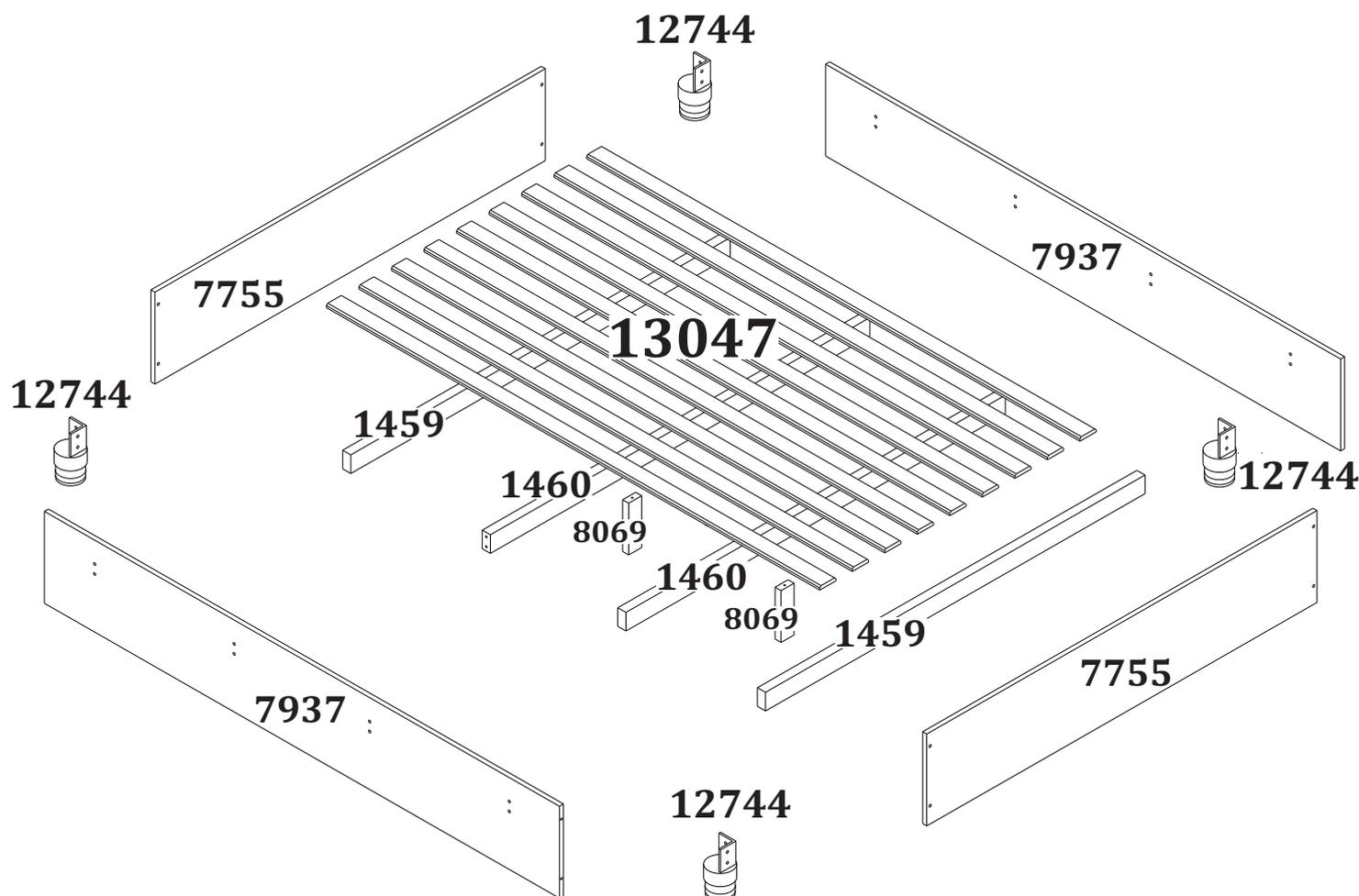
**1** Fixe as barras (7937) nos painéis (7755) utilizando os parafusos (2558). Em seguida, fixe os travessões (1459/1460) nas barras (7937) utilizando os parafusos (2558).
