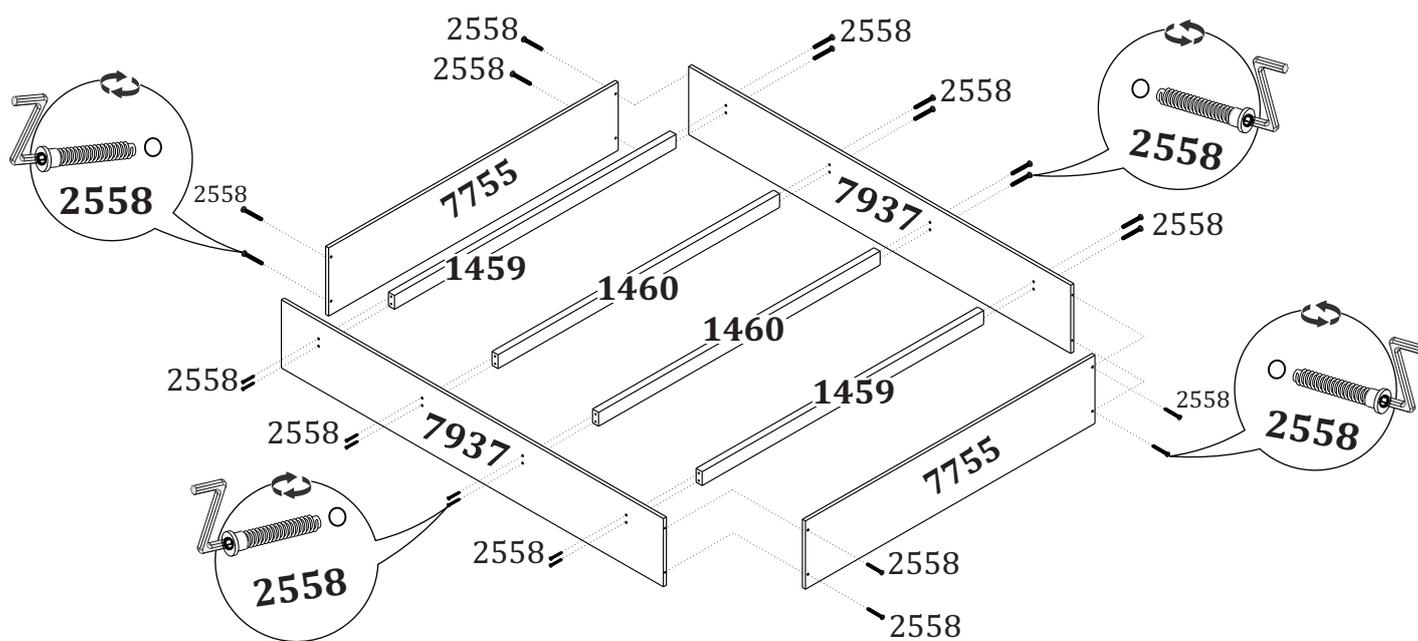
**2** Fixe os pés (12744) nos painéis (7755) e nas barras (7937) utilizando os parafusos (9292). Em seguida, fixe o quinto e sexto pé (8069) no travessão central (1460) utilizando os parafusos (2551).
