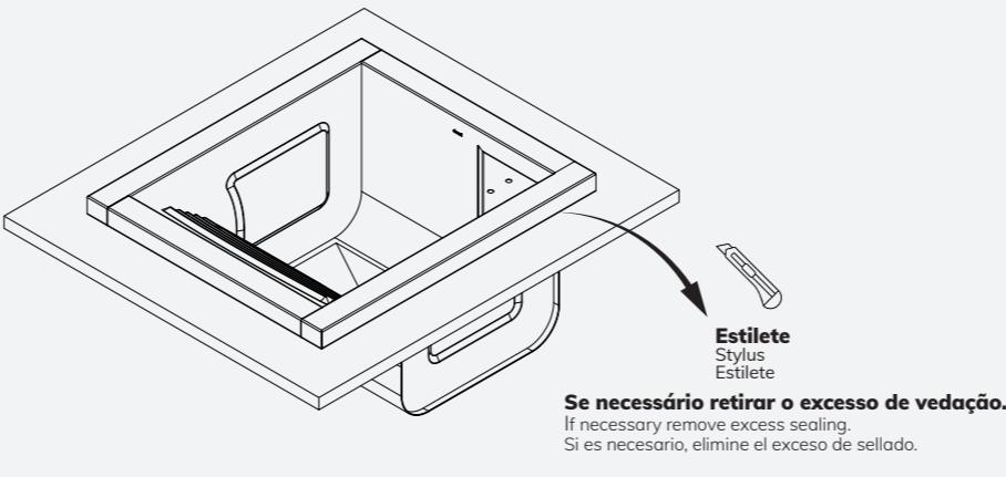
Procedimento para instalação em alvenaria | Procedure for installation in masonry | Procedimiento para la instalación en mampostería
