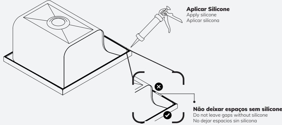
4 Fixar a pedra na cuba | Fix the stone in the tub | Fijar la piedra en la bañera
