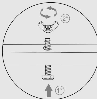
Desenrosque a porca borboleta do parafuso francês, após unir os dois módulos encaixe o parafuso francês nos furos dos dois módulos e rosqueie a porca borboleta até que fique firme.
