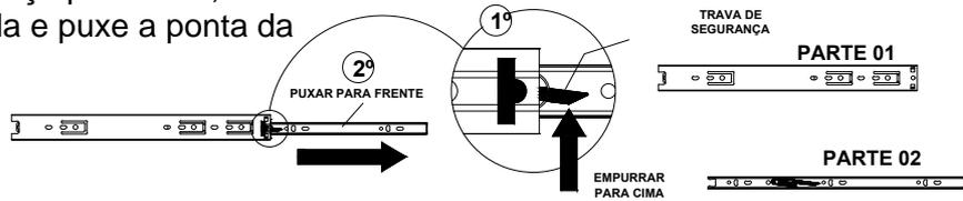
**15°** - Parafuse a parte **01 da corrediça (desenho abaixo)** na lateral inferior direita e na divisão inferior direita, seguindo as marcações, usando **03 parafusos Ch. Ph. 3,5x10 c/ pt.** para cada corrediça.
