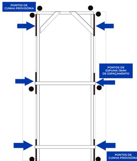
**4° Passo:** aguarde 24 horas para que a espuma cure. Depois, corte o excesso da espuma com um estilete e retire as cunhas, os espaçadores e as ripas.
