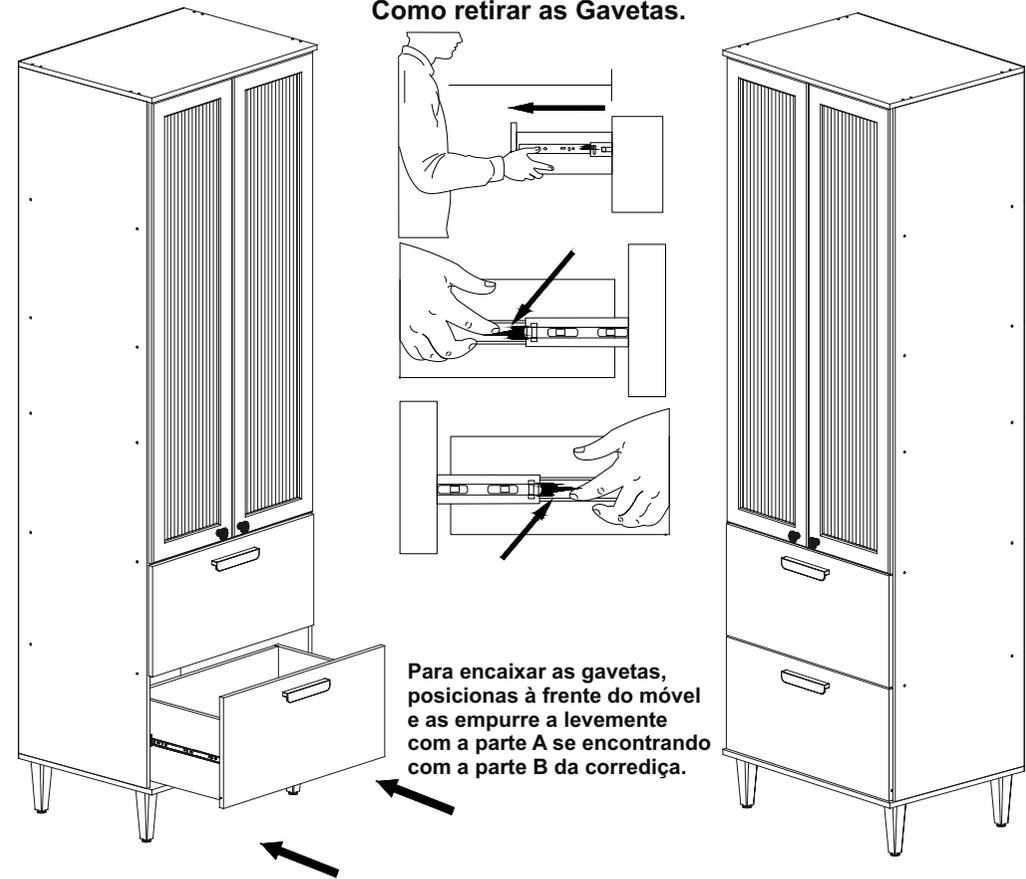
Para encaixar as gavetas, posicionas à frente do móvel e as empurre a levemente com a parte A se encontrando com a parte B da corredeira.
