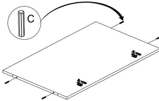
**Passo 7:** Fixar peças 01, 04, 05, 06, 07 e 08 as peças 02 e 03 com o parafuso 5x40 (D).
