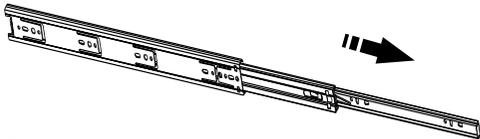
Para separar as partes da corrediça, puxe o engate que esta na parte traseira da corrediça (desenho ao lado) no sentido anti-horário, separando as duas partes, para facilitar a fixação no móvel.
