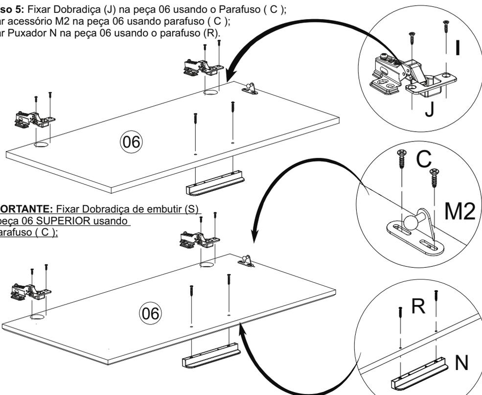
**IMPORTANTE:** Fixar Dobradiça de embutir (S) na peça 06 SUPERIOR usando o Parafuso ( C );
