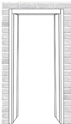
Após a fixação das guarnições no batente, fazer acabamento com a massa branca, e o kit estará pronto.
