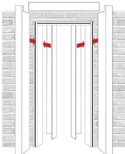
Após a fixação do batente no vão, instalar as guarnições regulando a aba conforme a espessura da parede.
