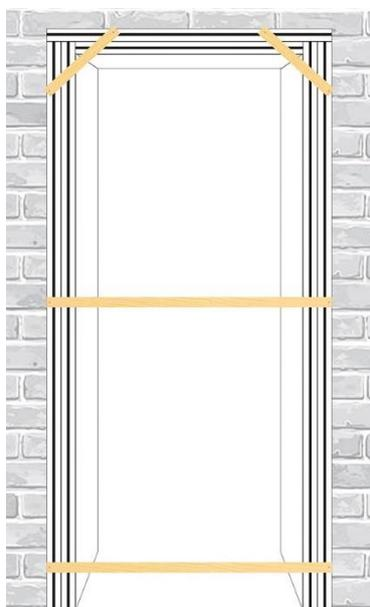
Após a fixação da cabeceira, importante fixar travessas ao longo do batente afim de garantir que as medidas entre as laterais fiquem iguais, instalar o batente no vão da parede com espuma de poliuretano e aguardar 24 horas até a completa secagem.
