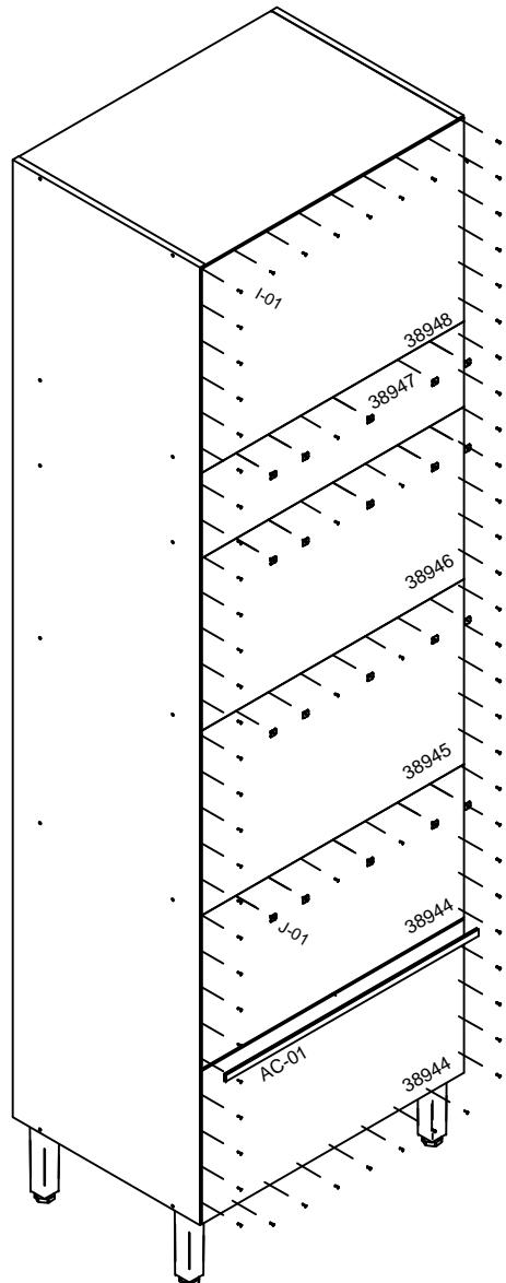
**Passo 1:** Usar parafusos **B-08** para fixar os trilhos telescópicos nas laterais direita e esquerda.
