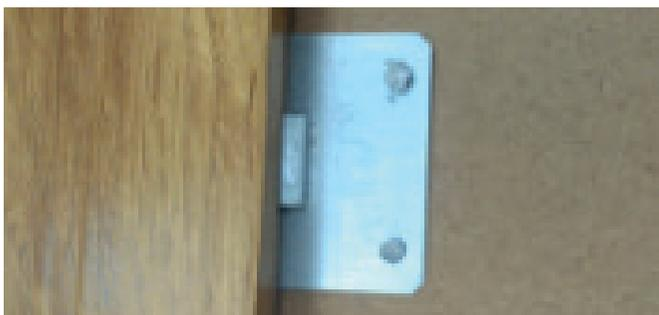
Preparar a próxima peça da mesma forma e acoplar o lado macho da segunda peça no lado fêmea da primeira peça. Caso necessário, utilizar um alicate para melhorar suavemente a área do encaixe macho que estiver travada no pino fixado na presilha da outra peça.
