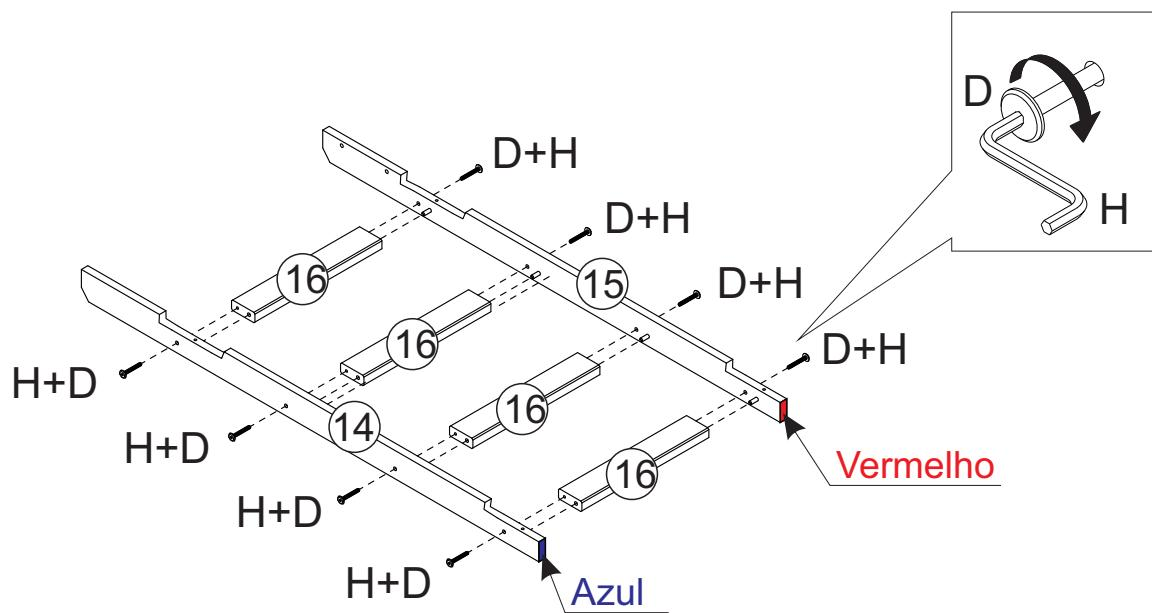
**20** Encaixe as peças (6) na montagem da escada, e fixe com os parafusos (D), conforme desenho.
