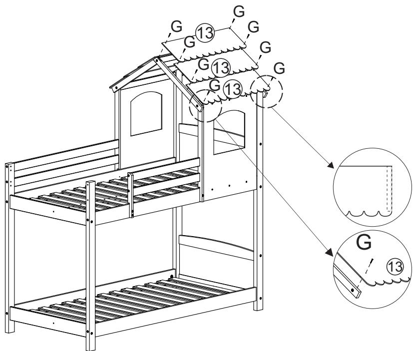
**18** Da mesma forma que o passo anterior, com auxilio de uma escada, fixe os telhados (13) com os parafusos (G), conforme desenho.
