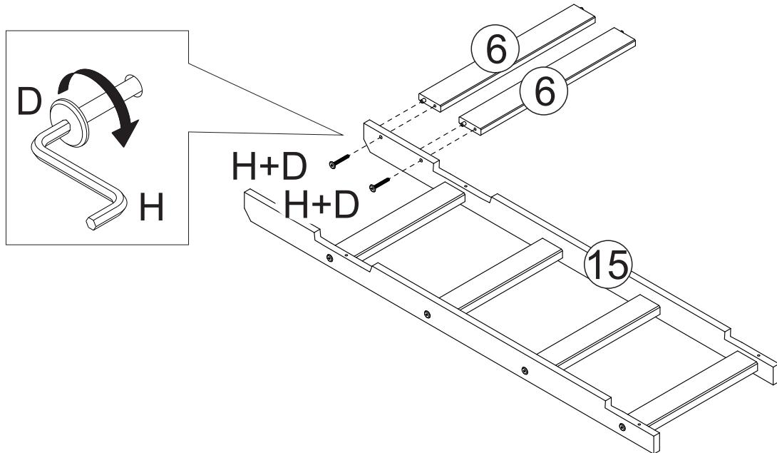
**21** Encaixe a montagem da escada no pé e fixe com os parafusos (C) e nas travessas das peseiras com os parafusos (D).
