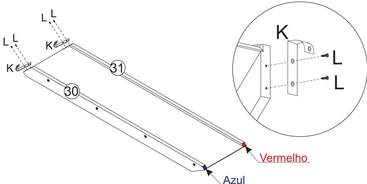
**24** Encaixe o escorregador na abertura e fixe com os parafusos (L), conforme mostra no detalhe.
