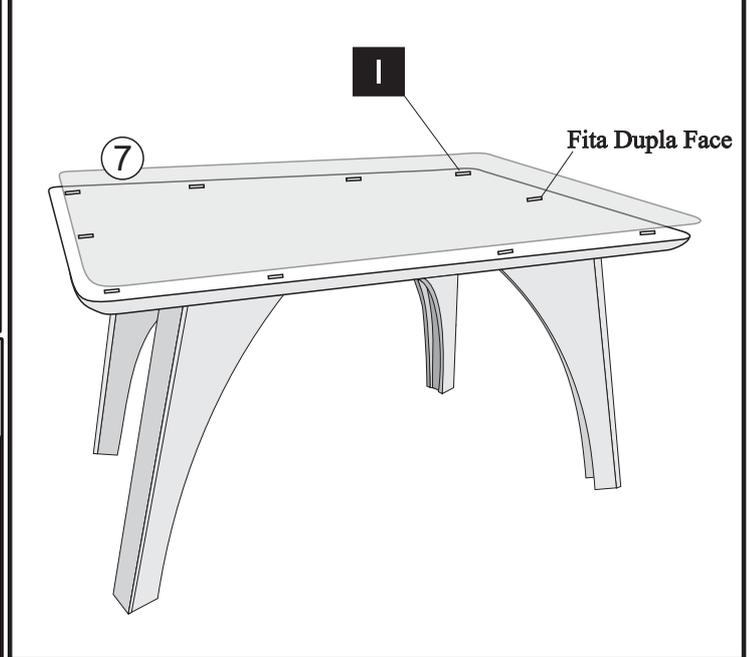
4º - FIXAR OS PÉS DA MESA UTILIZANDO CAVILHAS 08X20 PARA CENTRALIZAR OS PÉS NO TAMPO, EM SEGUIDA FINALIZAR A MONTAGEM UTILIZANDO PARAFUSOS 04X25 FLANGEADO E AS SAPATAS DESLIZADORA + COLA.
