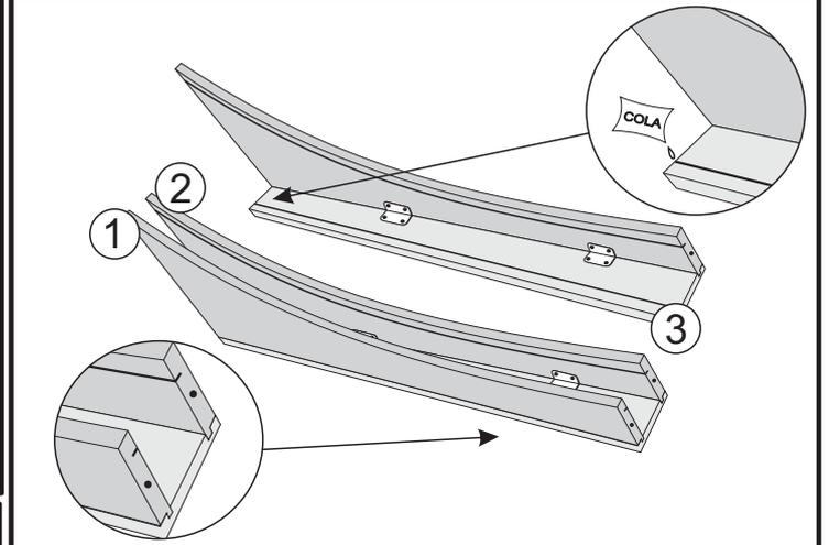
3º - FIXAR O SOBRETAMPO Nº04 UTILIZANDO PARAFUSOS 07X40 cab. 10 mm + CHAVE ZETA. CORRER O FORRO UTILIZANDO COLA.
