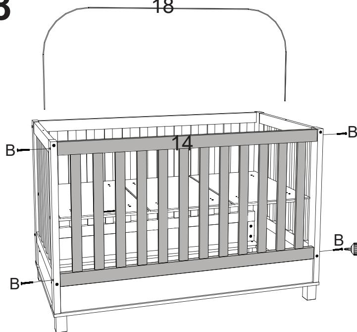
Utilizar a parafusadeira com o torque em 15 para fixar a grade e para fixar o lastro.
