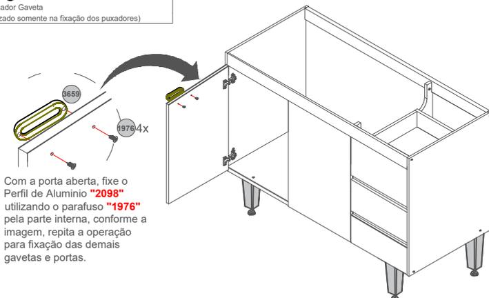
Com a porta aberta, fixe o Perfil de Alumínio "2098" utilizando o parafuso "1976" pela parte interna, conforme a imagem, repita a operação para fixação das demais gavetas e portas.
