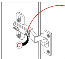
Se precisar alinhar as portas para o centro parafuse a letra **(C)**. Para alinhar as portas em direção as laterais desparafuse a letra **(C)**.
