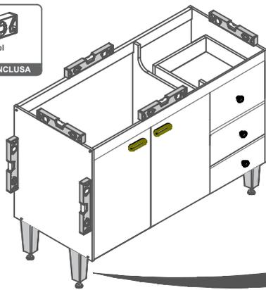
Ajustar os níveis de acordo com as irregularidades do piso, deixando o gabinete nivelado. (Conforme o desenho)
