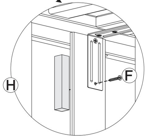
Faça a fixação do espaçador (H) junto ao estrado conforme mostra desenho, pois o mesmo deverá ser utilizado posteriormente, caso a cama precise ser remontada.
