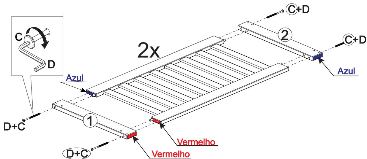
**4** Encaixe as peças (11) nas peças (3 e 4), conforme desenho.
