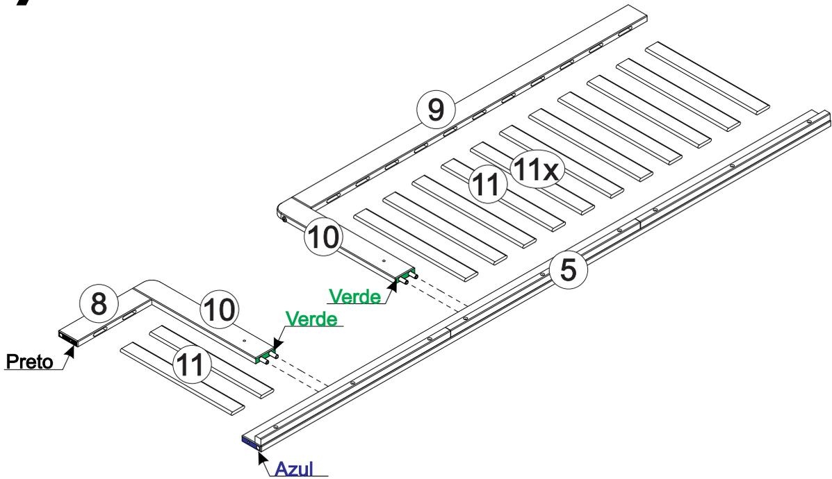
**8** Insira as cavilhas (A) nas peças (8,9 e 10), depois fixe as peças (10) conforme desenho.
