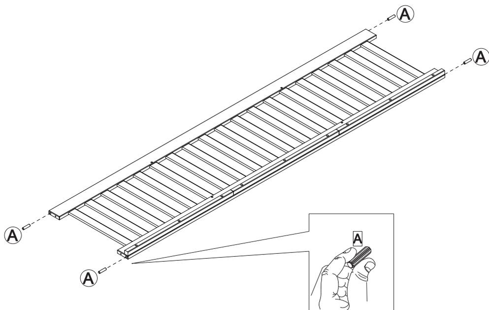
**6** Insira as cavilhas (A) nas peças (8,9 e 10), depois fixe as peças (10) conforme desenho.
