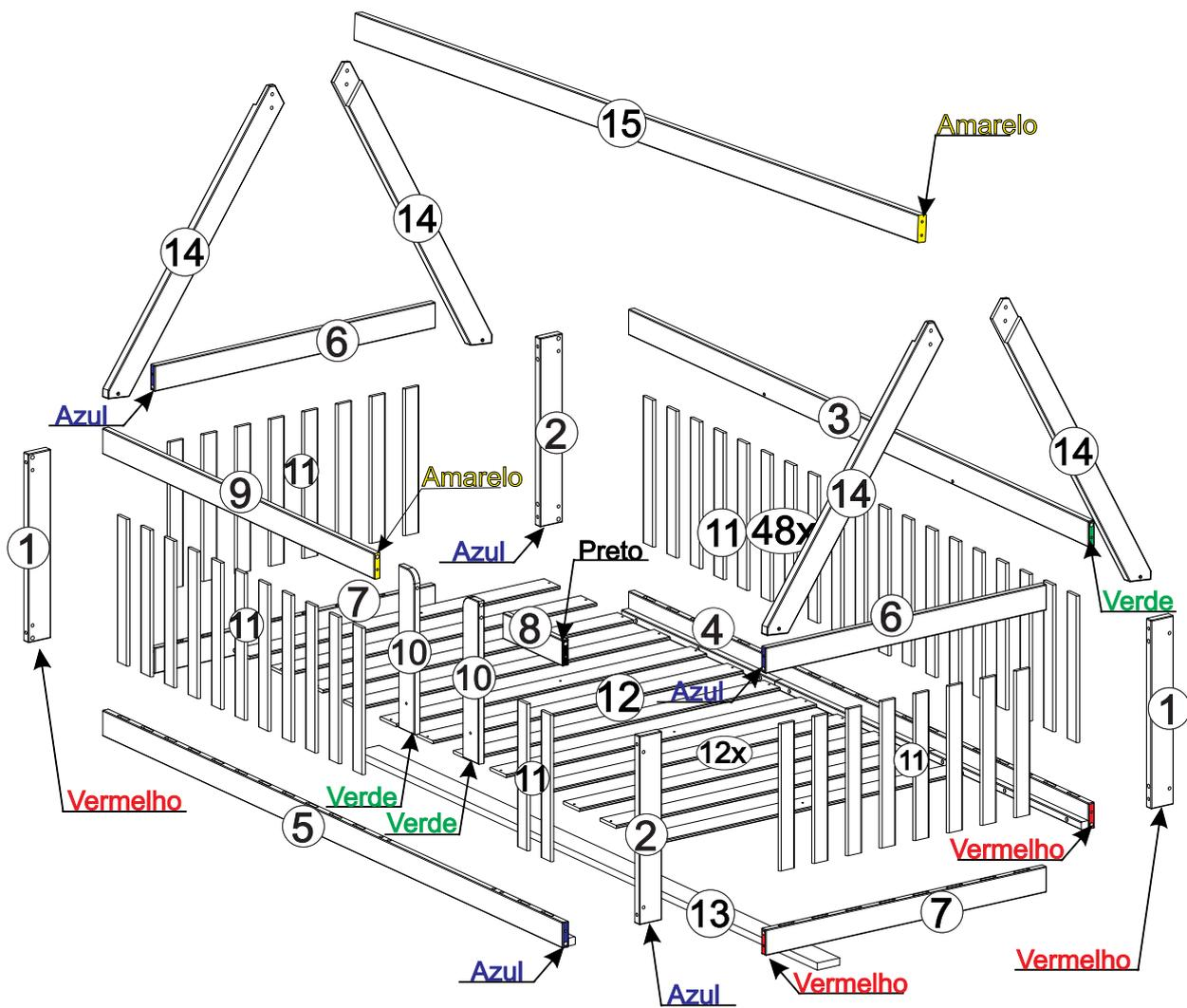
**1** Encaixe as peças (11) nas peças (6 e 7), conforme desenho.
