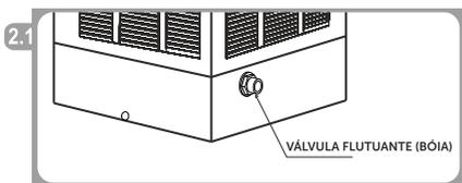
2.1 Válvula flutuante poderá estar disponível em alguns modelos selecionados. Para estes modelos, faça os ajustes necessários para que ocorra o abastecimento automático de água no Climatizador. Garanta a conexão correta do tubo de entrada de água na Válvula flutuante (Bóia) como forma a evitar vazamentos.
