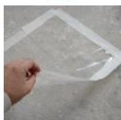
**Através de método manual:** Coloque pedaços de plástico (mínimo 40x40cm) em diversos pontos do contrapiso. Prenda toda a borda do plástico com fita adesiva e aguarde 24 horas. Se o plástico “transpirar” ou se o contrapiso ficar mais escuro nessa área significa que a água ainda está evaporando e, portanto, o contrapiso está úmido. Deixe o local ventilado e repita o teste alguns dias depois.
