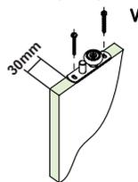
Instalação do deslizador inferior na porta
