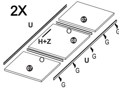
Montagem do deslizador superior no topo da porta
