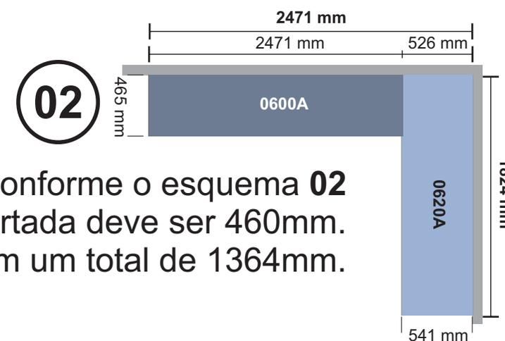
Para montar conforme o esquema 02 a medida cortada deve ser 460mm. Ficando com um total de 1364mm.
