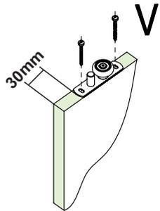
Instalação do deslizador inferior na porta
