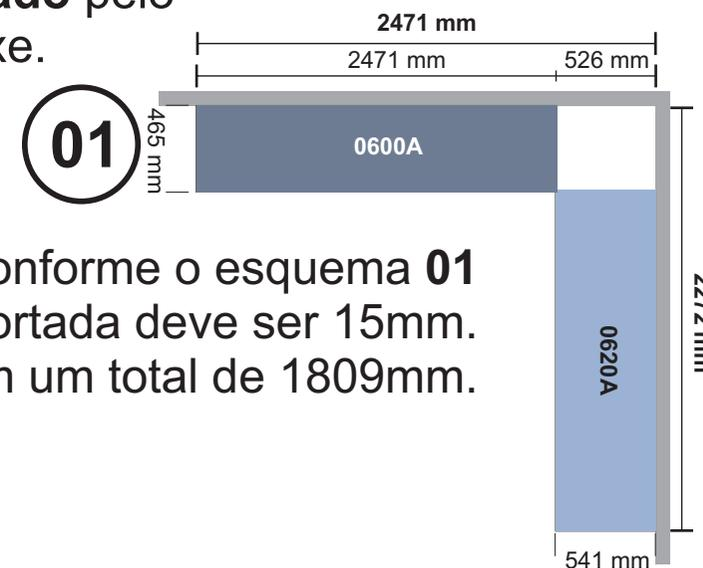
Para montar conforme o esquema 01 a medida cortada deve ser 15mm. Ficando com um total de 1809mm.
