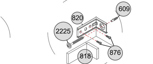
**FIXAÇÃO NA PAREDE**
