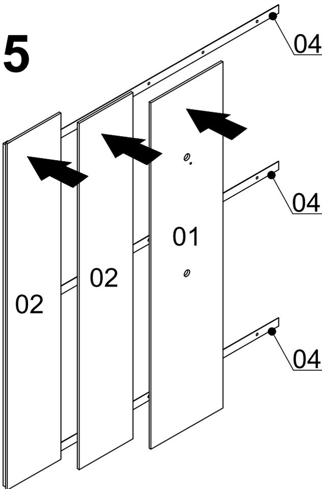
*Encaixe os painéis na régua n°04, na sequência conforme mostra o desenho.*
