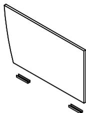
Recorte um pedaço pequeno da espuma E.V.A. para encaixar junto com a sapata plástica.
