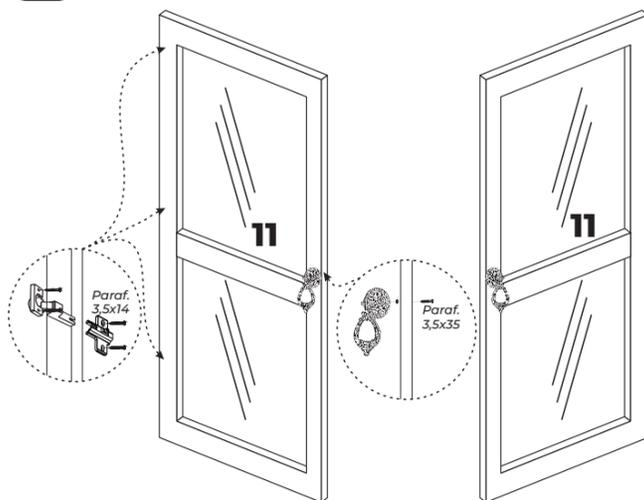
Fixar as dobradiças nas portas com parafuso 3,5x14, fixar os puxadores nas portas com parafuso 3,5x35 conforme figura acima.
