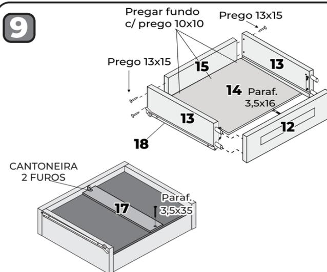
Fixar as laterais das gavetas na frente com cantoneiras 4 furos e cavilha 6x30 depois fixar as costas com prego 10x10, fixar o fundo, colocar o reforço da gaveta (17) c/ paraf. 3,5x35 e cantoneira 2 furos c/ parafuso 3,5x14 e por último colocar a corrediça conforme figura acima.
