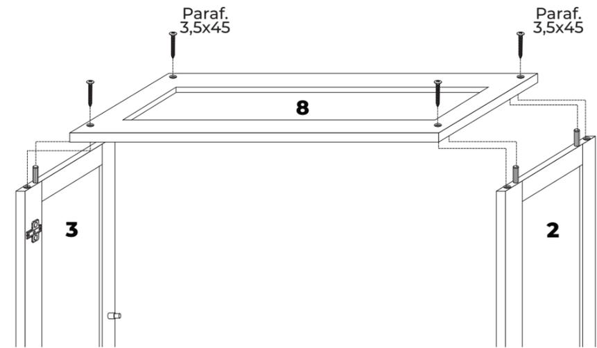
Fixar tampo 08 nas laterais 02 e 03 com parafusos 3,5x45 e 2 cavilhas em cada lado conforme figura acima.
