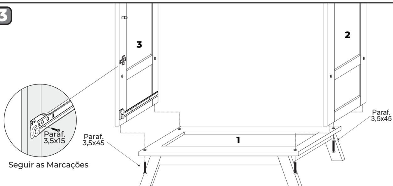
Fixar laterais 02 e 03 na base 01 com parafusos 3,5x45 conforme figura acima.
