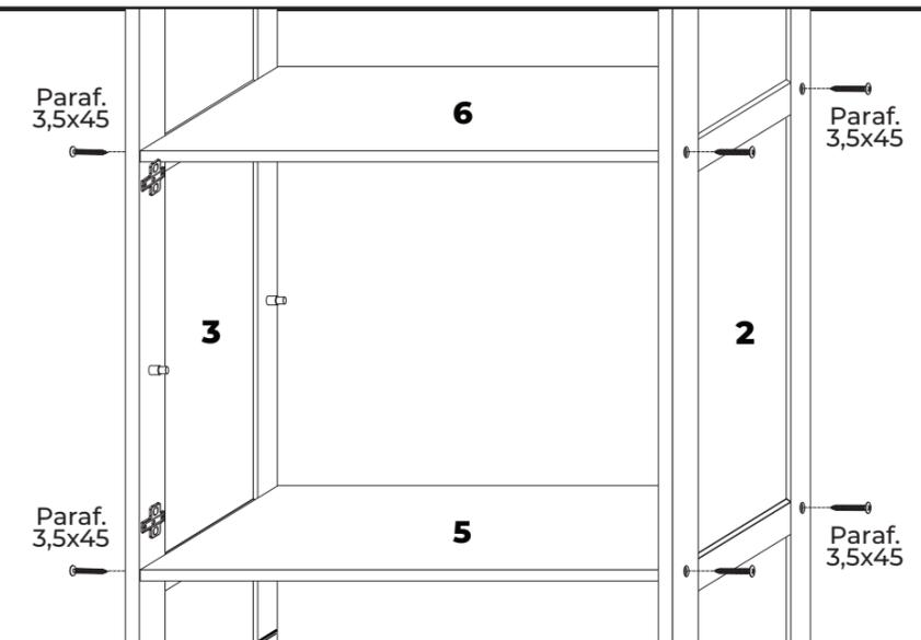
Fixar tampo da gaveta 05 e prateleira central 06 nas laterais 2 e 3 com um parafuso 3,5x45 conforme figura acima.
