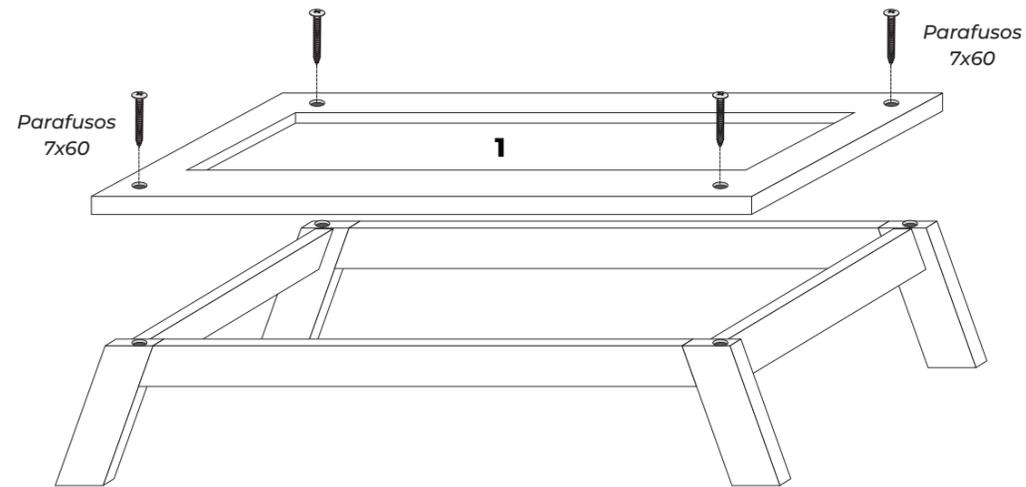
Fixar base 1 sobre os pés já montados utilizando parafusos 7x60 conforme figura acima.
