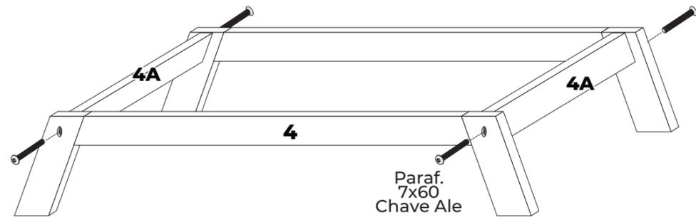
Parafusar os pés n° 02 nas travessas rodapé n° 4A de fora para dentro utilizando parafuso 46x60 usando chave Ale como mostrado na figura acima.
