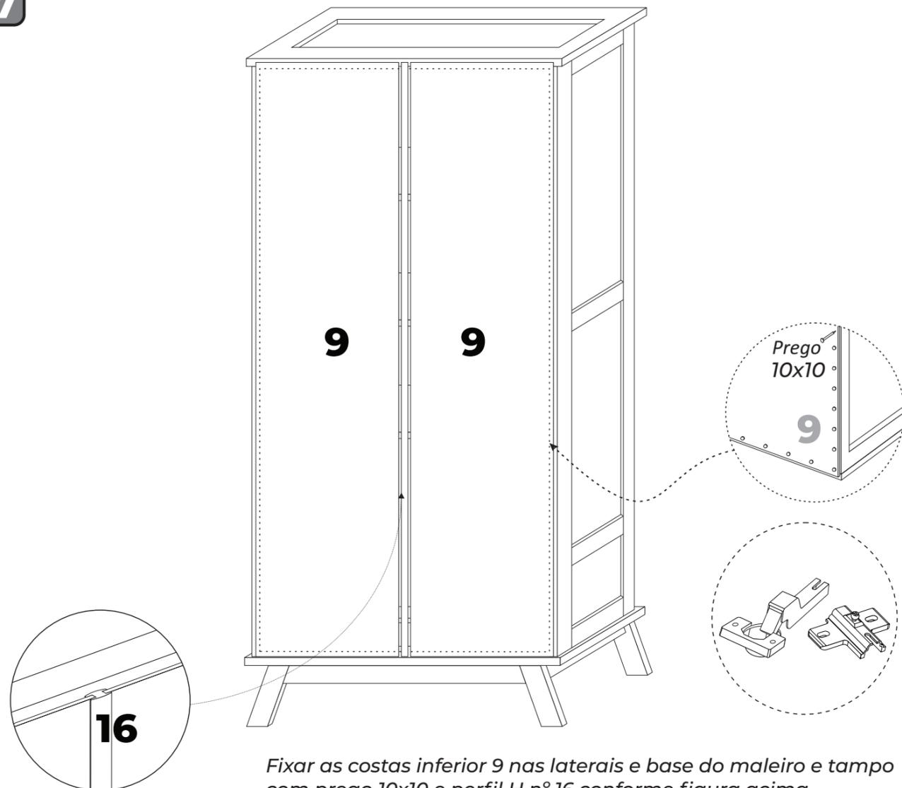
Fixar as costas inferior 9 nas laterais e base do maleiro e tampo com prego 10x10 e perfil H n° 16 conforme figura acima.
