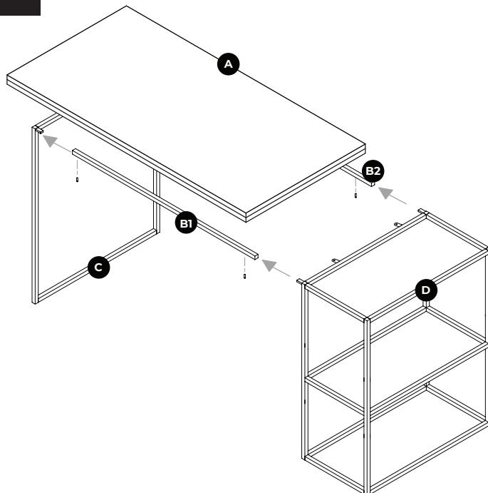
1. Para a montagem da mesa, encaixe as hastas com dois furos (B1, B2) nas esperas de encaixe das duas estruturas maiores (C e D) como na imagem. Posicione todos os parafusos allen e firme todos os com a mão, depois aperte com a chave allen.
