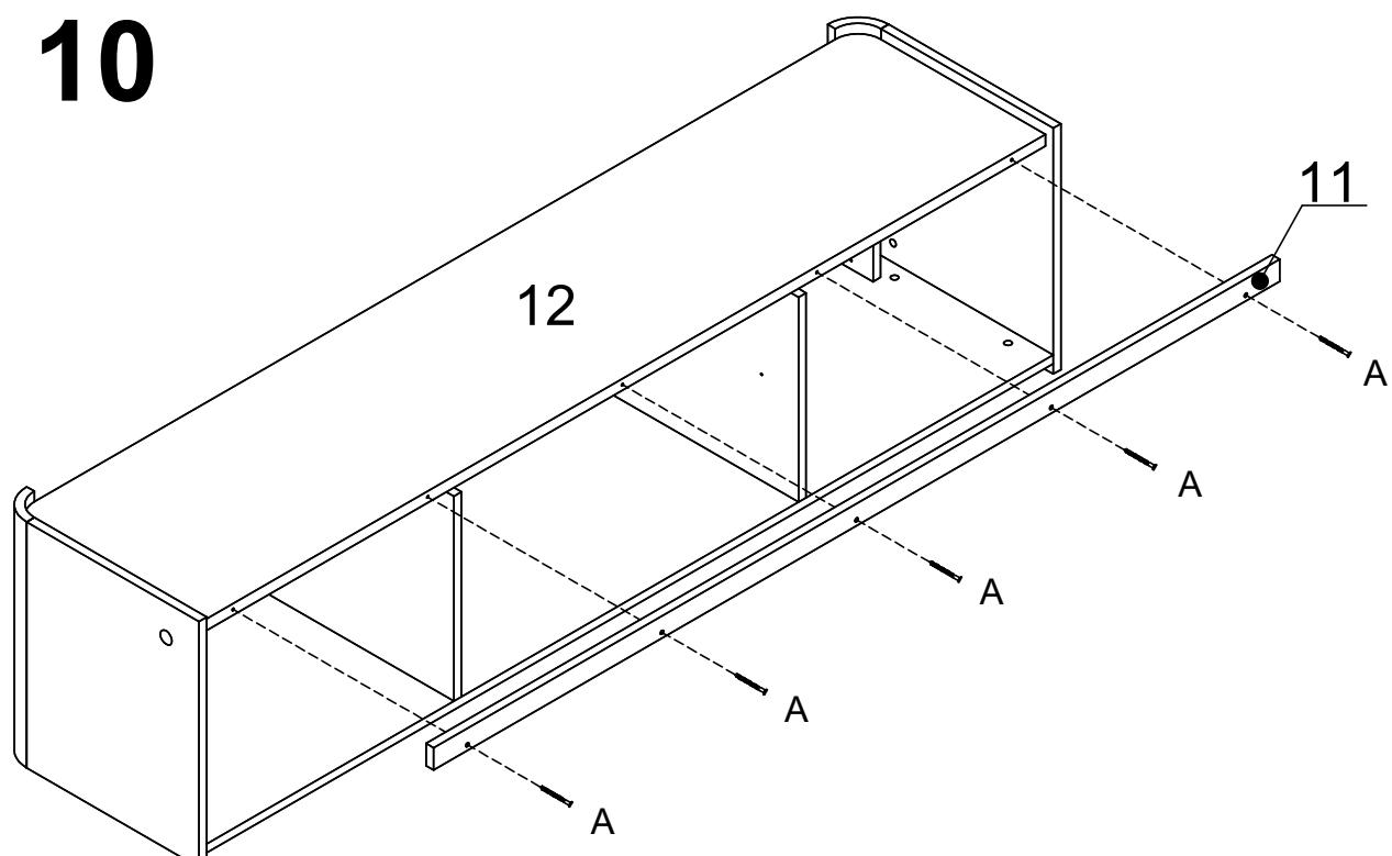
Após o Rack montado, acessando por trás,
