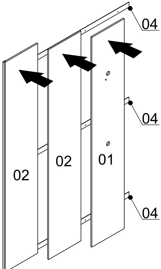
Encaixe os painéis na régua nº04, na sequência conforme mostra o desenho.
