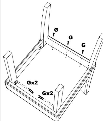
Utilize uma chave Philips com os parafusos 5x40 (G) para reforçar a fixação dos pés frontais (3) e o assento da cadeira (2).
