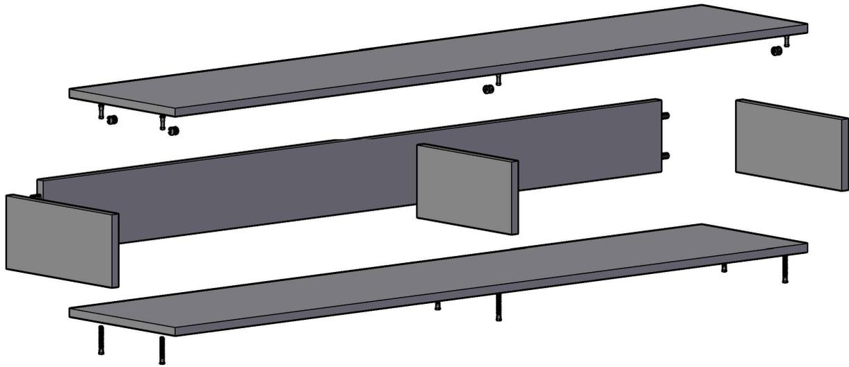
Use parafuso estrutural na base para fixar lateral e divisão, depois utilize parafuso minifix no tampo travando com o tambor.
