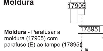
**Moldura** - Parafusar a moldura (17905) com parafuso (E) ao tampo (17895)
