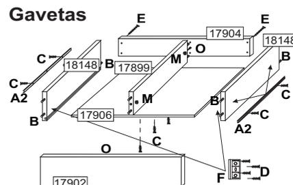
**Gavetas** - Parafusar as laterais de gaveta ao lenço da gaveta com o parafuso (E); encaixar o fundo no rasgo, encaixe a divisão (17899) e parafuse de baixo para cima com o parafuso (C) e cavilha (B) fixe a frente com a cavilha (B) e cantoneira (F); a corredeira (A2) deve ser parafusada na lateral (18148) com o parafuso (D) na posição horizontal.
