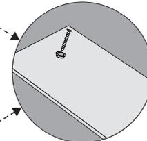
USAR O ANEL FIXADOR JUNTAMENTE COM O PARAFUSO.
