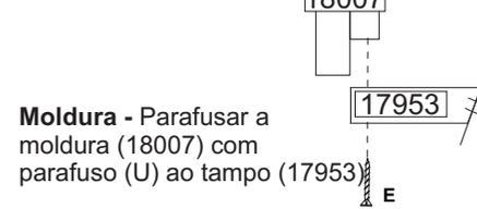
**Moldura** - Parafusar a moldura (18007) com parafuso (U) ao tampo (17953)
