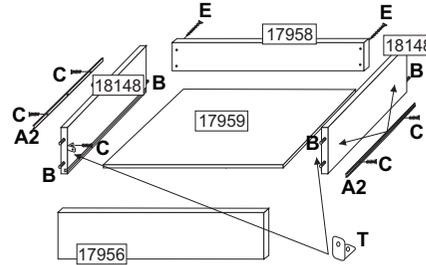
**Gavetas** - Parafusar as laterais de gaveta ao lenço da gaveta com o parafuso (E); encaixar o fundo no rasgo, fixe a frente com a cavilha (B) e cantoneira (T); a corredeja (A2) deve ser parafusada na lateral (18148) com o parafuso (C) na posição horizontal.
