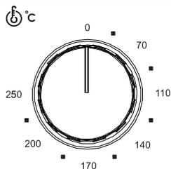
Controle de temperatura varia do desligado até 250°C
