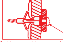
4 - Posicione o armário com a cantoneira sobre a bucha e fixe-o com um parafuso
