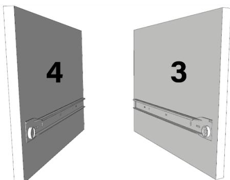
FIXAR A CORREDIÇA "C3" NAS LATERAIS "3, 4" USANDO PARAFUSOS "P1" EM CADA LATERAL, NAS DEVIDAS MARCAÇÕES EXISTENTES.
