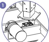
1 Insira a cabeça hexagonal da coluna (B) na calha de fixação.
