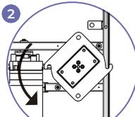
2 Gire a coluna após inseri-la, fazendo os parafusos da calha de fixação encaixar nos dentes da cabeça hexagonal da coluna.
