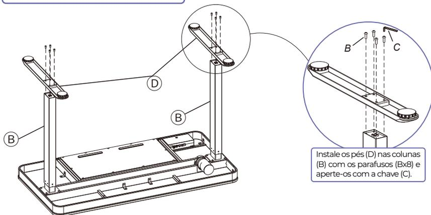
Instale os pés (D) nas colunas (B) com os parafusos (Bx8) e aperte-os com a chave (C).
