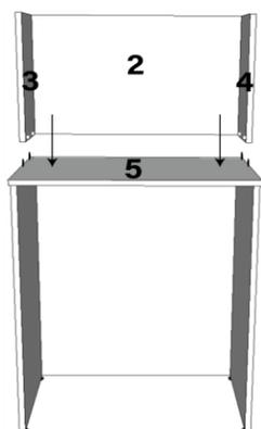
\*ENCAIXE A MONTAGEM SUPERIOR NO TAMPO INFERIOR "5".
