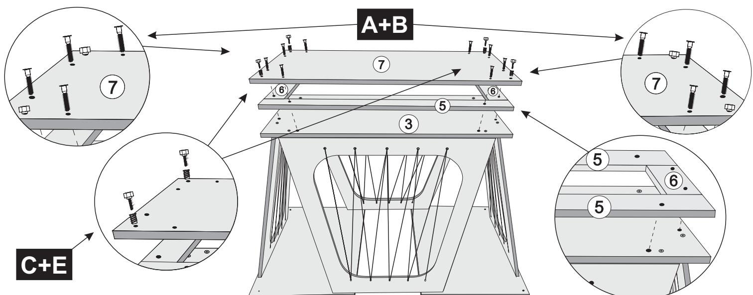
\*CENTRALIZAR A BASE NO TAMPO N°8 1,35x0,90 COPO SEGUINDO AS MEDIDAS. TRavar COM PARAFUSOS 04X25 NAS EXTREMIDADES DAS PEÇAS N°4.
