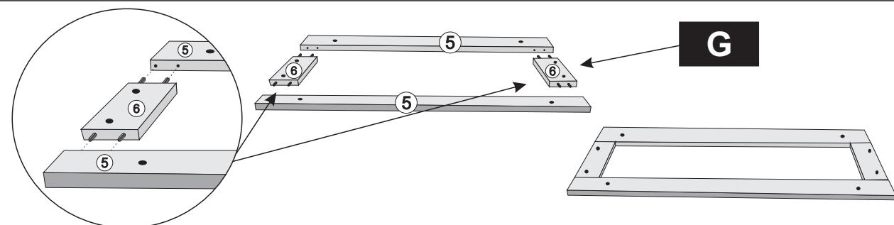
4º- UNIR AS PEÇAS N°5, N°6 E N°7 COM A PEÇA N°3 UTILIZANDO PARAFUSOS 07X40 CAB. 13mm+CHAVE ALEN ZETA, APÓS TRavar AS PARTES, UTILIZAR BUCHA AMERICANA+SAPATA REGULÁVEL NA PEÇA N°7.
