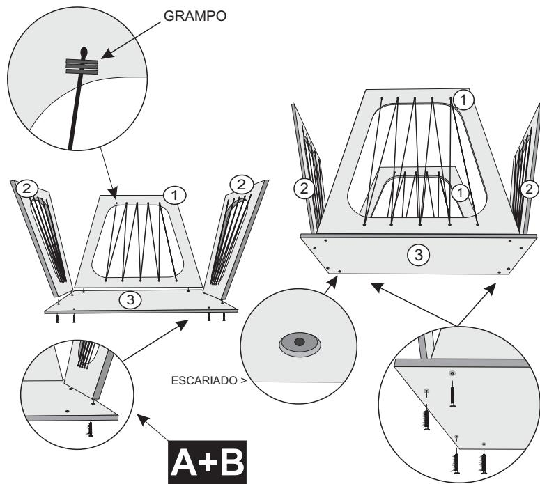
2º- FIXAR PEÇAS N°4 NAS LATERAIS N°1 E N°2 UTILIZANDO PARAFUSOS 07X40 CAB 13mm+CHAVE ALEN ZETA. PEÇAS N°4 ESCARIADO PARA CIMA.
