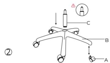
Pressione as 5 rodinhas (A) nos encaixes da base. Encaixe o cilindro de gás (C) na base (B).
