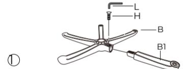
Apoie a base (B) sobre o plástico transparente protetor que acompanha o produto, para não arranhar. Encaixe, na base, a perna sobressalente(B1), e parafuse-a (H).
