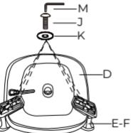
Posicione o assento (D) virado para baixo sobre uma superfície, encaixe os braços (E), depois de posicionados, insira os parafusos (J) e arruelas (K), aperte-os utilizando a chave Allen.
