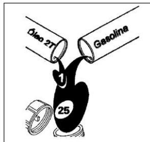
O combustível utilizado pelo equipamento é uma mistura de gasolina
