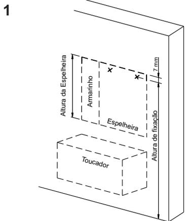
Verifique a altura de fixação em relação ao piso e marque com um lápis a altura superior e inferior da espelheira na parede. Como mostra a figura acima, trace uma marcação 7mm abaixo da borda superior e faça um x onde serão feitos os furos para fixação da espelheira na parede.
