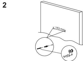
Após confirmadas as medidas, fure a parede com uma broca 6 e coloque as buchas 6 na parede. Fixe os parafusos 4x40 nas buchas deixando 5 mm para fora, para encaixe nas alhetas da espelheira.
