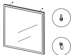
Encaixe a espelheira na parede. Posicione-a alinhando o furo maior da alheta com o parafuso fixo na parede. Obs.: a cabeça do parafuso passará pelo furo maior (A) da alheta e encaixará no furo recortado menor (B).
