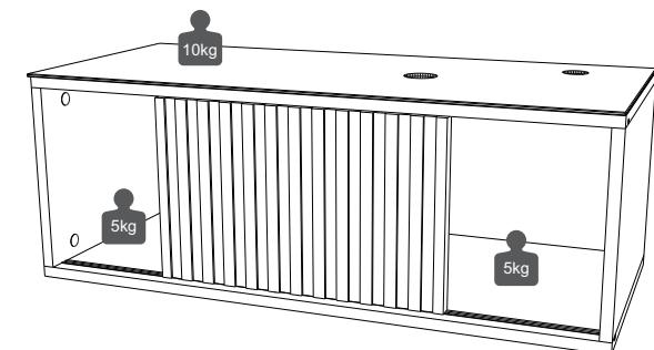
Se necessário, utilize um nível. Marque os furos com um lápis, passando-o pelo furo da barra de fundo. Afaste o gabinete da parede e com uma trena ou metro confirme se as medidas entre as marcações estão conforme os furos do gabinete. Fure a parede com broca n. 8 e coloque a bucha 8 na parede. Posicione o gabinete alinhando os furos com as buchas na parede e fixe com parafusos 5x50.
