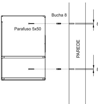
Posicione o produto na parede de forma que esteja nivelado (utilize um nível) e marque com lápis os furos na parede, passando-o pelos furos do produto. Afaste-o da parede e com uma trena ou metro confirme se as medidas entre as marcações estão conforme os furos do produto. Fure a parede com broca n.8. Coloque a bucha 8 nos furos, posicione o produto alinhando os furos com as buchas na parede. Fixe o produto na parede com parafusos 5x50 conforme o desenho.
