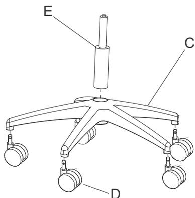
Pressione as 5 rodinhas (D) nos encaixes da base. Encaixe o cilindro de gás (E) na base (C)
