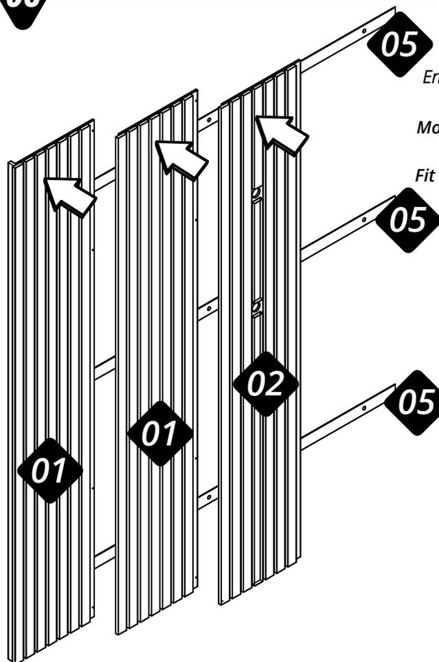
Encaixe os painéis na régua n°05, na sequência conforme mostra o desenho.
