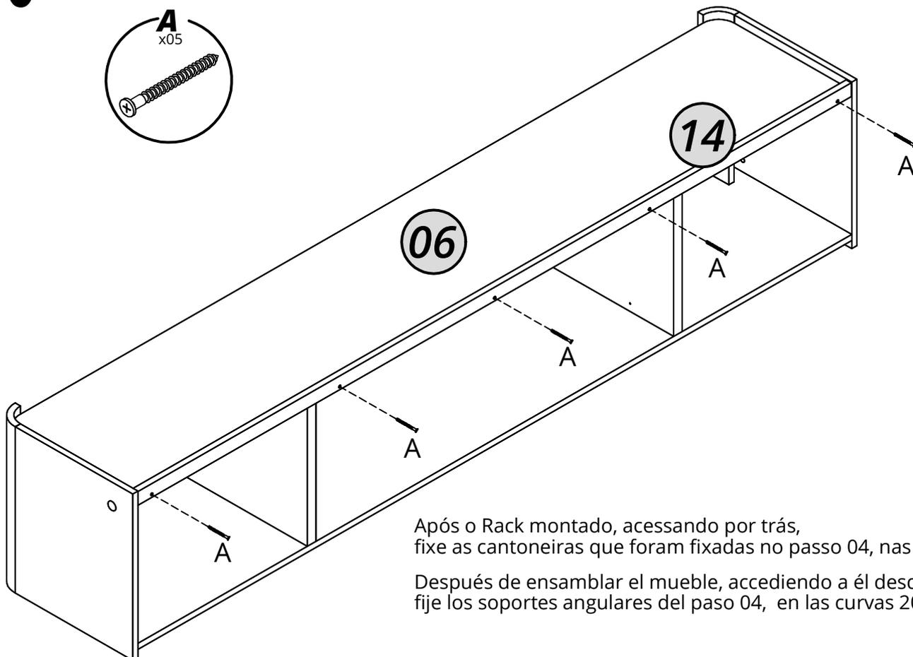
Após o Rack montado, acessando por trás, fixe as cantoneiras que foram fixadas no passo 04, nas curvas 20.
