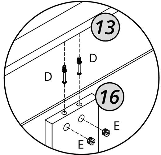
Atenção: conforme for encaixando a curva do nicho no canal, já ir apertando o tambor minifix em cada etapa.
