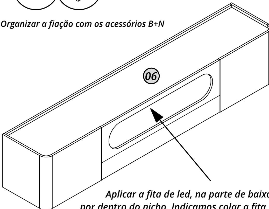
Aplicar a fita de led, na parte de baixo do tampo, por dentro do nicho. Indicamos colar a fita bem no fundo do nicho
