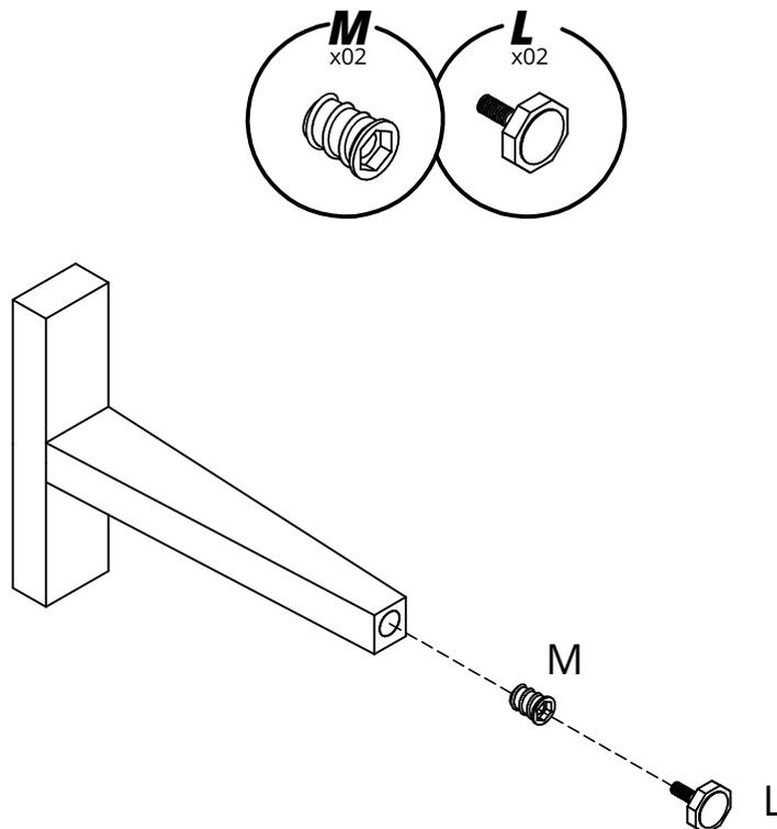
*Instalar a sapata de regulagem nos pés de apoio de madeira.*
