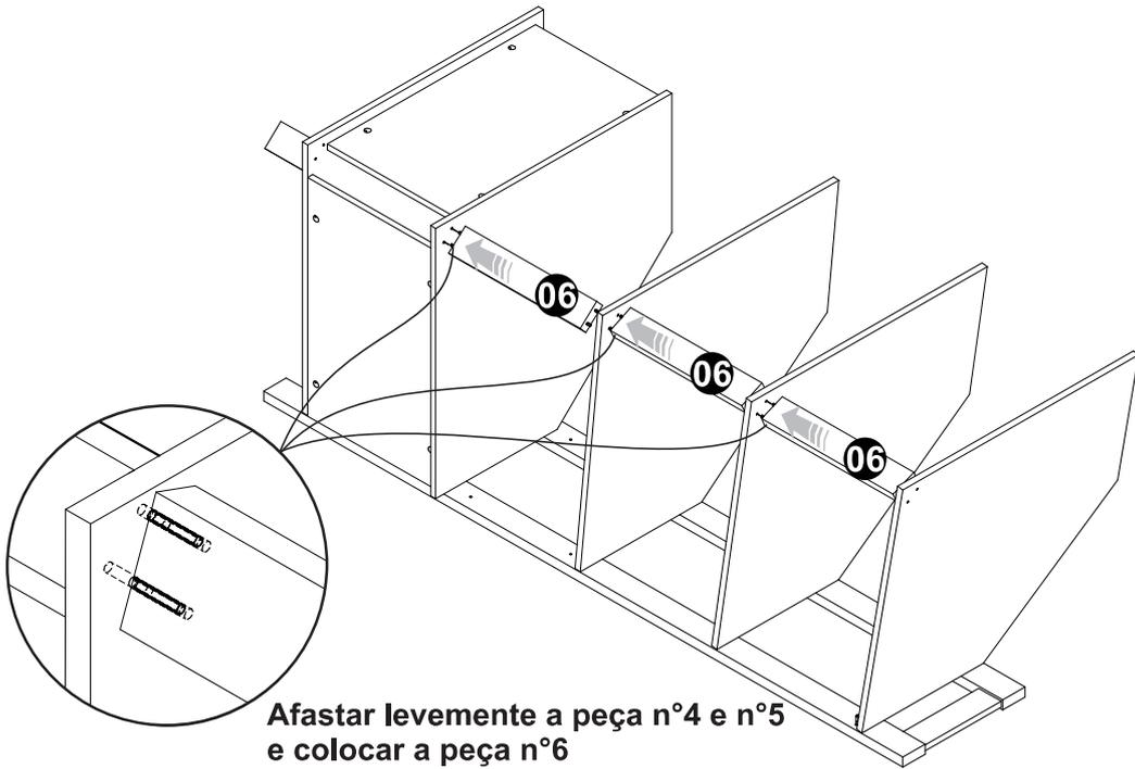
Afastar levemente a peça n°4 e n°5 e colocar a peça n°6
