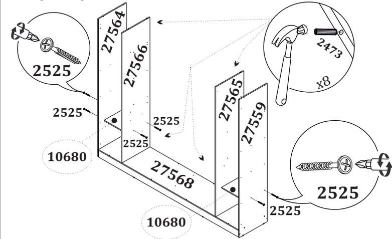
**4** Encaixe a divisão (27567) na base com as cavilhas (2473). Fixe as prateleiras (25938) nas divisões (27565/27566) com os parafusos (2525) e na divisão (27567) utilizando as cavilhas (2473) e a haste mini fix (21199) apertando com o tambor mini fix (2580).
