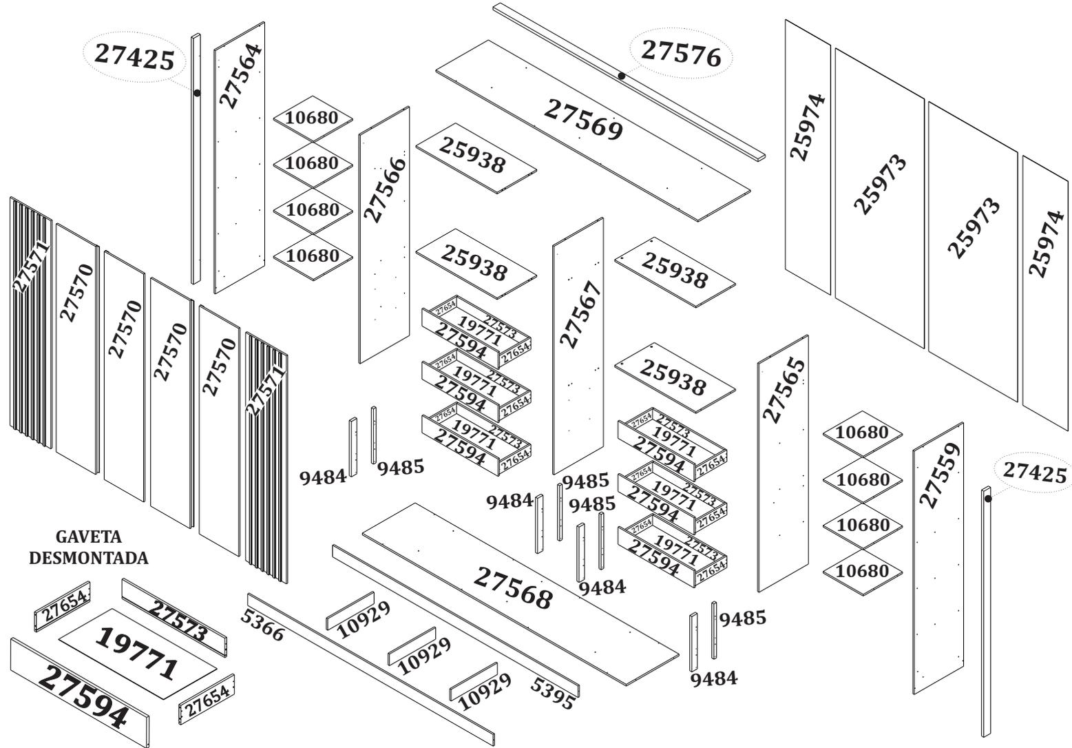
**1** Fixe as sapatas (11063) nas laterais (27559/27564) e nos rodapés (5366/5395) com os parafusos (2504). Fixe as laterais (27559/27564) nos rodapés (5366/5395) utilizando os parafusos (2525) para prender no rodapé traseiro (5395) e os parafusos (2505) para prender no rodapé frontal (5366) e em seguida, fixe as travessas (10929) entre os rodapés utilizando as cantoneiras (2466) e os parafusos (2504).
