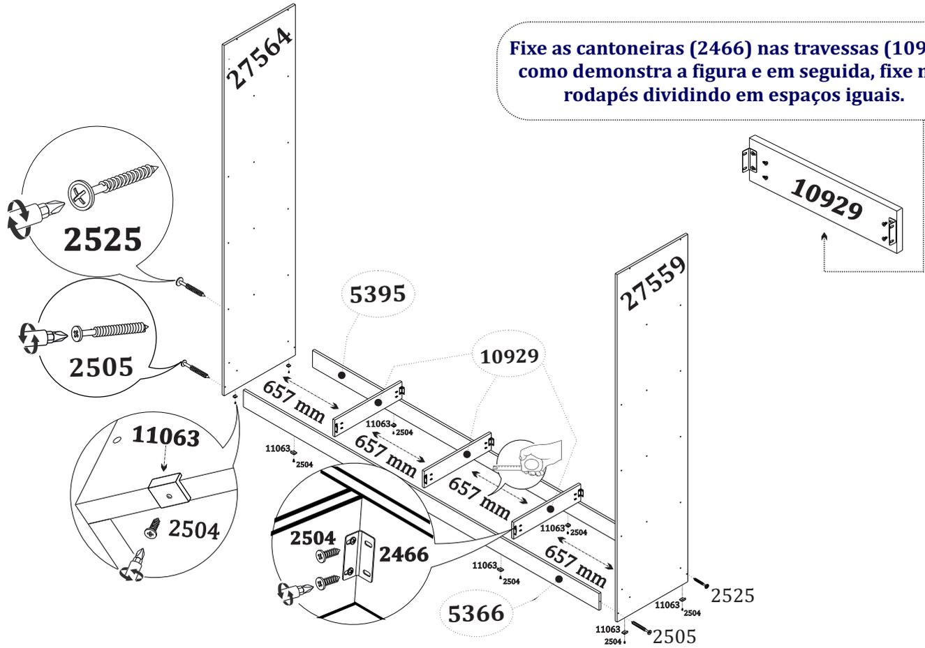
**2** Fixe a base (27568) nas laterais (27559/ 27564) com os parafusos (2525) e nos rodapés utilizando os parafusos (2505).
