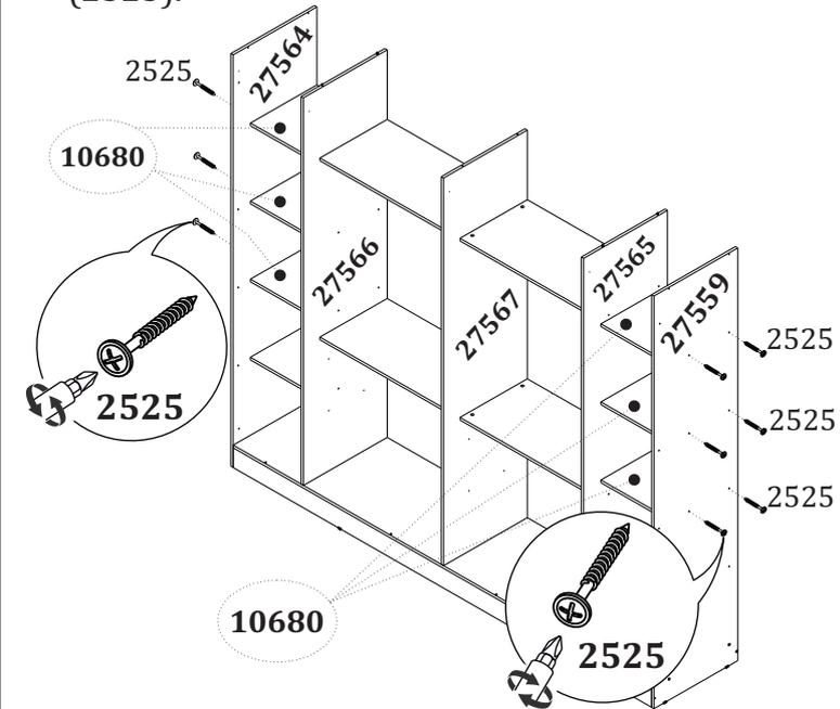
**6** Encaixe o tampo (27569) nas cavilhas (2473) das divisões e em seguida, com os parafusos (2525) fixe o tampo nas laterais (27559/27564).
