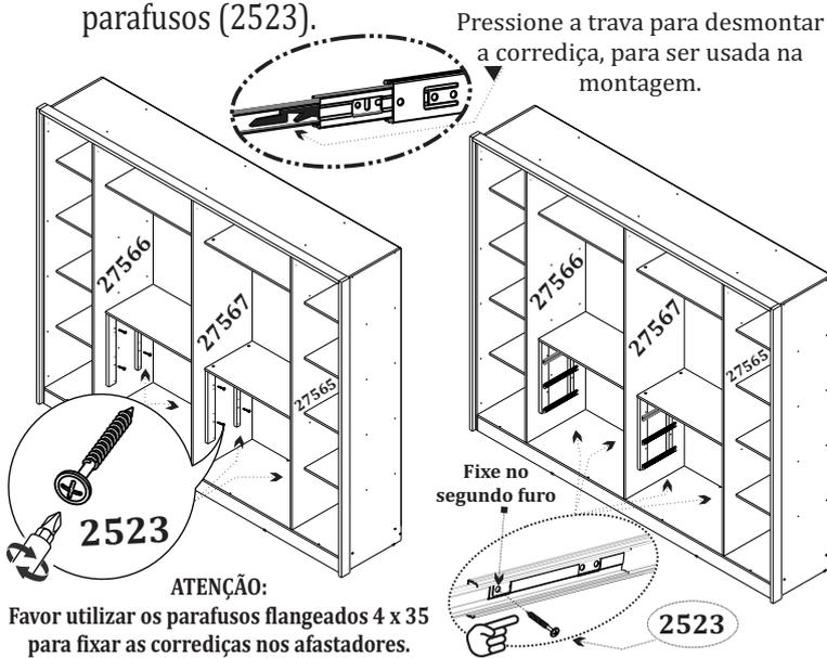
**11** Fixe as gavetas e em seguida, coloque os suportes de cabideiro (11794) utilizando os parafusos (2504).
