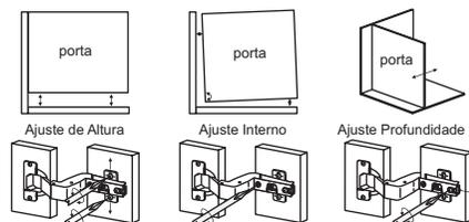
Posicionar e Parafusar as Portas '24' nas laterais e divisórias com parafuso 'D' nas dobradiças 'S', Fazer o alinhamento das portas.
