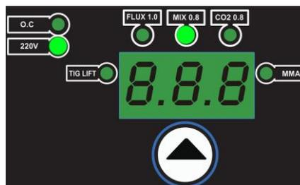
Os processos MIG Solid Wire (GMAW) e Flux Core (FCAW) utilizam polaridades diferentes (DCEP e DCEN). Assim, deve-se ajustar a máquina para quando for ser soldado arames sólidos ou fluxados. Para alternar entre eles, siga estas instruções:
