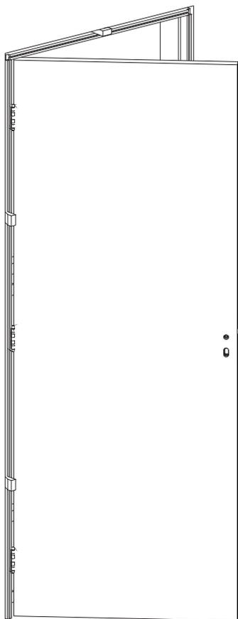
7º Passo: Aplicar espuma PU, em cada lado em três pontos, aproximadamente 20cm na altura das dobradiças. Após de 24 horas retirar os excessos de espuma para aplicar os alizares.
